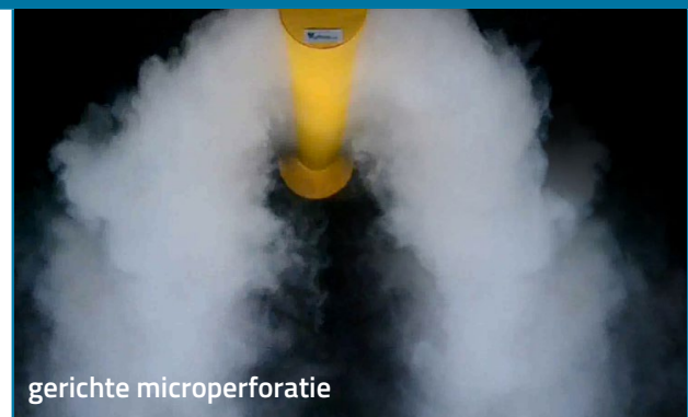
Voorbeelden van luchtstroompatronen gemaakt met rookproeven in het Prihoda R & D centrum
