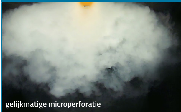
Voorbeelden van luchtstroompatronen gemaakt met rookproeven in het Prihoda R & D centrum
